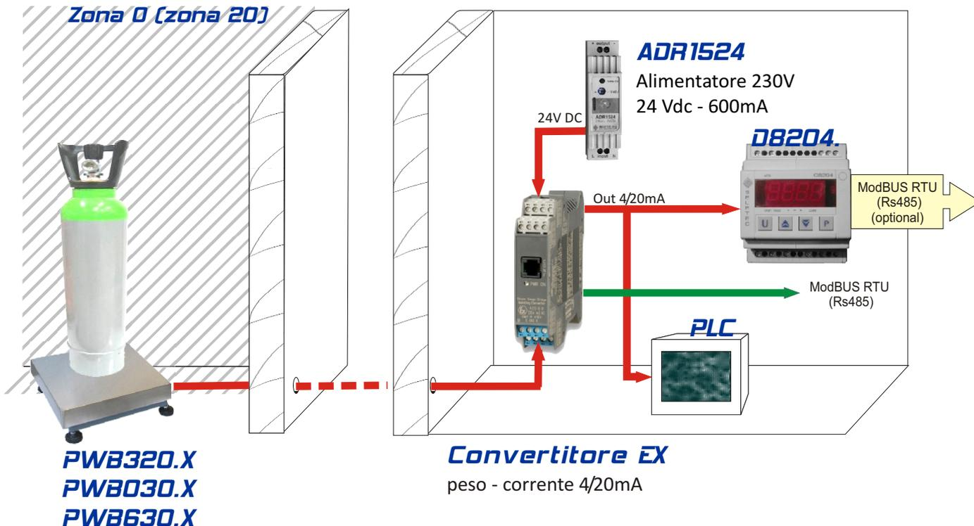
La fornitura comprende la piattaforma di pesatura e la barriera
